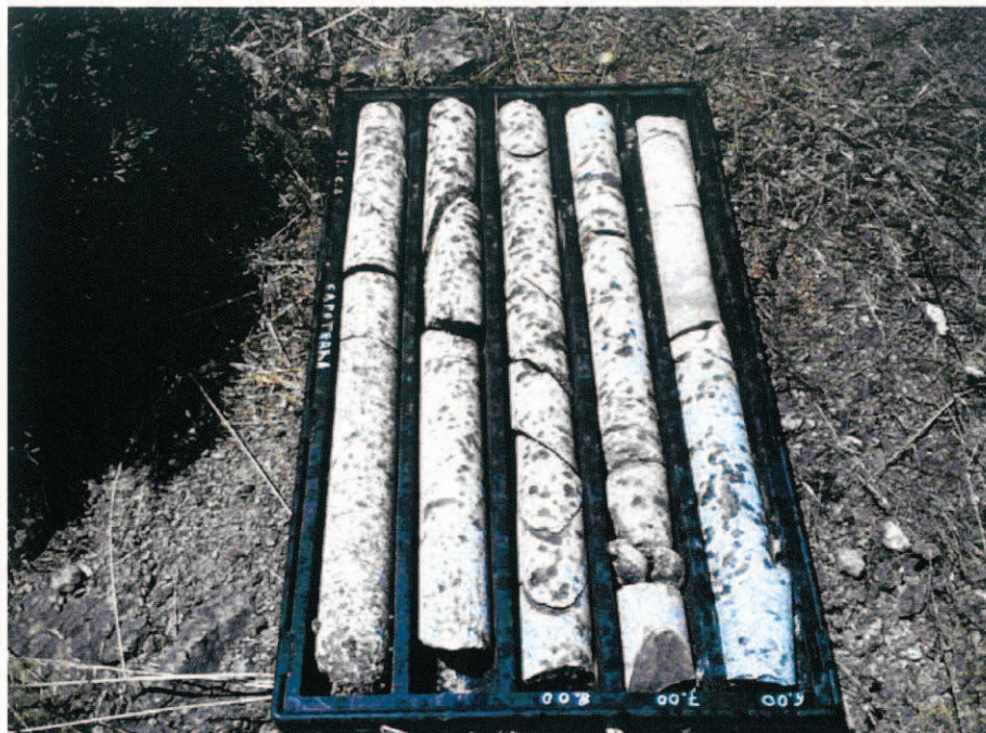
Carotaggio del sondaggio S9 (0-5m)
