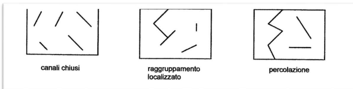
Fig. n.35 – Teoria della Percolazione, esempi di circolazione idrica in ammassi rocciosi fratturati (da Scesi, 2007):
