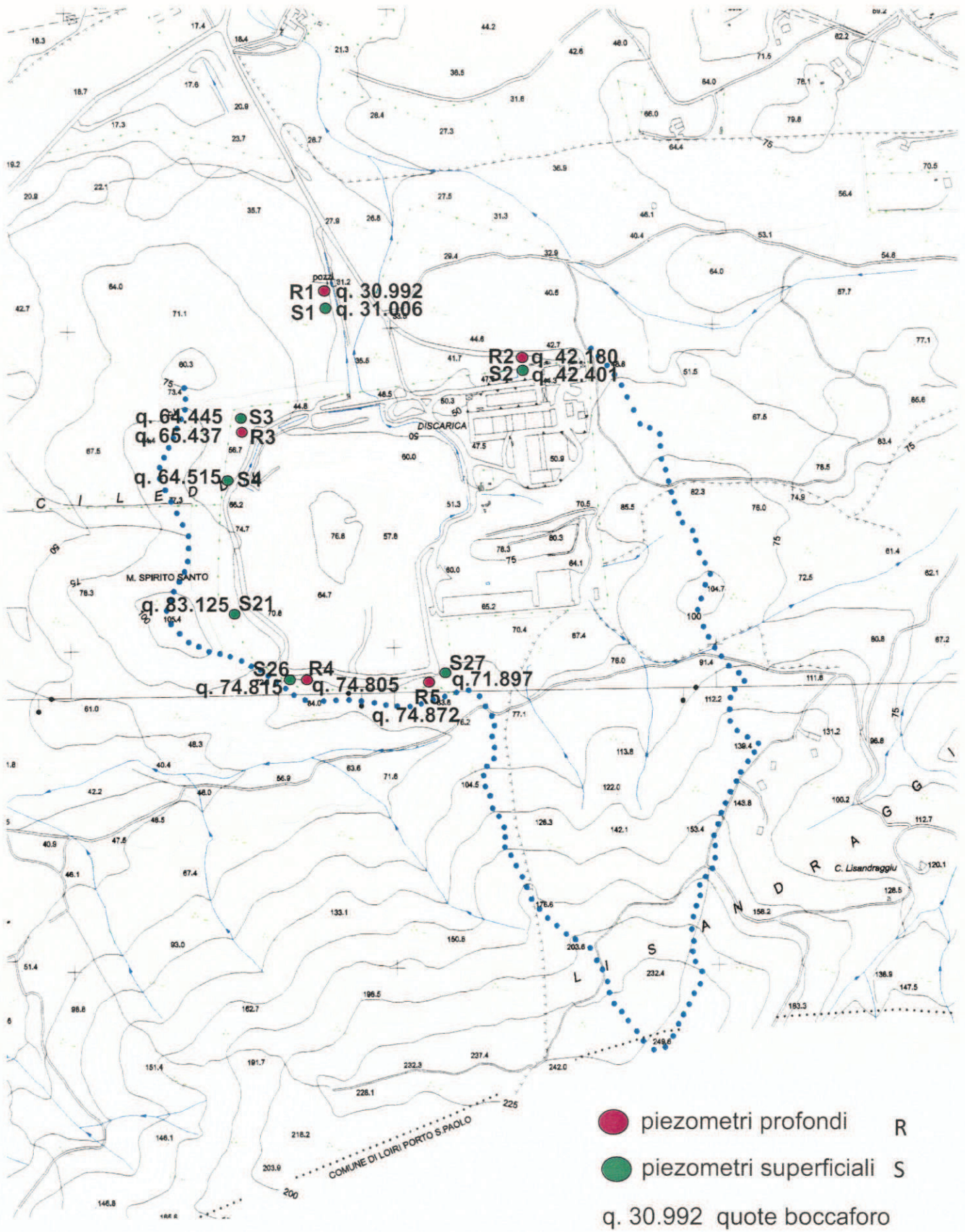
Rete monitoraggio piezometrico
