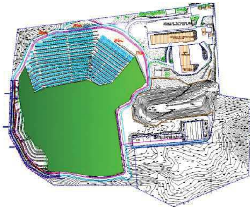
Fig.1 – Planimetria generale della piattaforma IPPC. A S-E il settore della nuova discarica con evidenza della relativa superficie topografica originaria.
